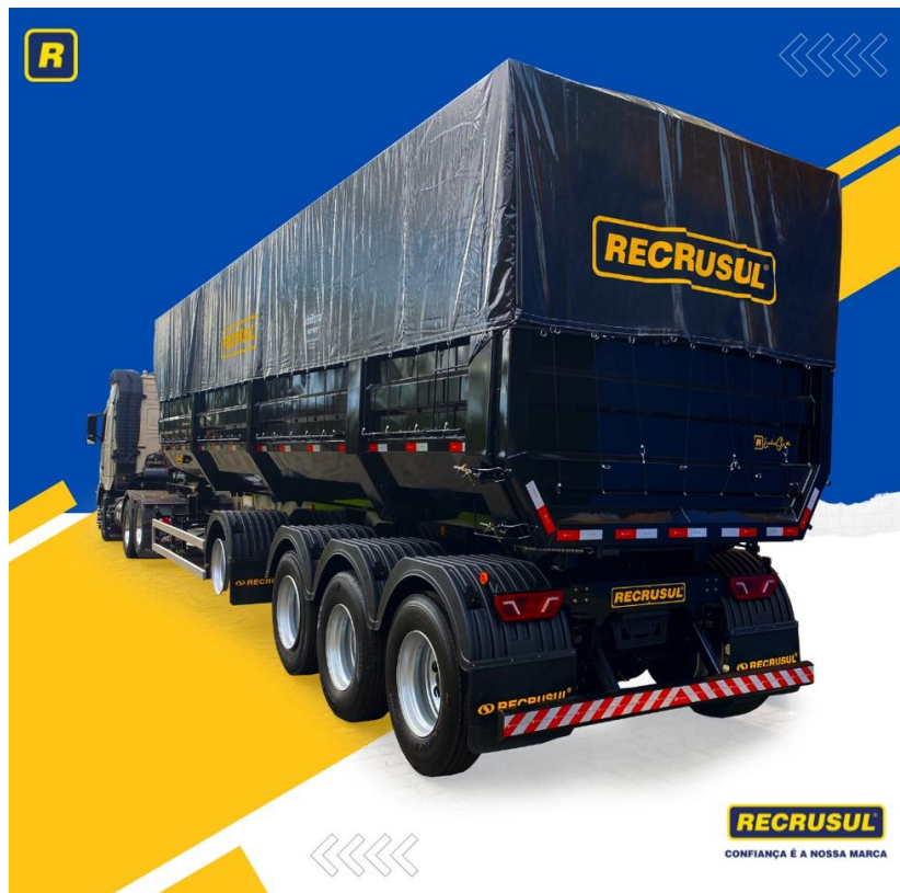
Figura 1 : Carreta graneleira basculante 4 eixos com 55 m 3 de capacidade de carga.
